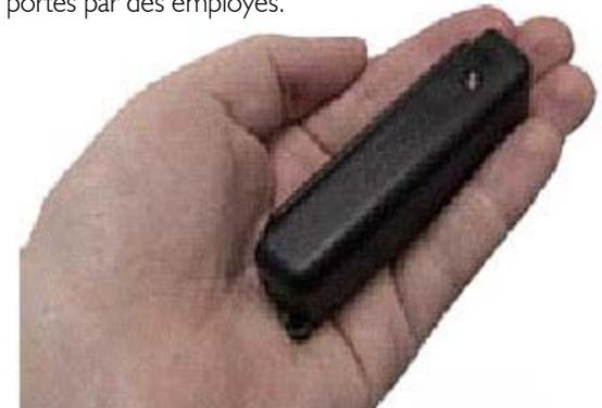
Figure 3A : Dos d'un appareil standard. Passez les doigts sur l'étiquette à l'arrière pour voir si l'appareil semble avoir été trafiqué.
