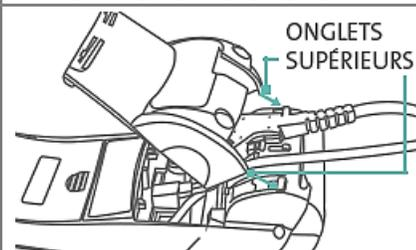
l. Refermez le panneau arrière et appuyez jusqu'à ce qu'il se verrouille. (Le câble du clavier NIP devrait passer par la fente située au milieu de l'appareil, entre le panneau fermé et le terminal.)
