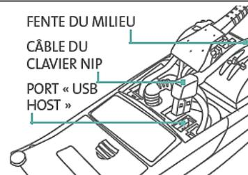
k. Remplacez le panneau arrière de sorte que les deux onglets situés aux coins supérieurs viennent s'insérer dans les ouvertures situées au haut du terminal.
