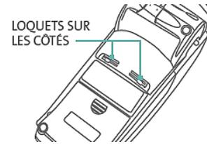
e. Appuyez simultanément sur les deux loquets et tirez pour soulever le panneau arrière.
