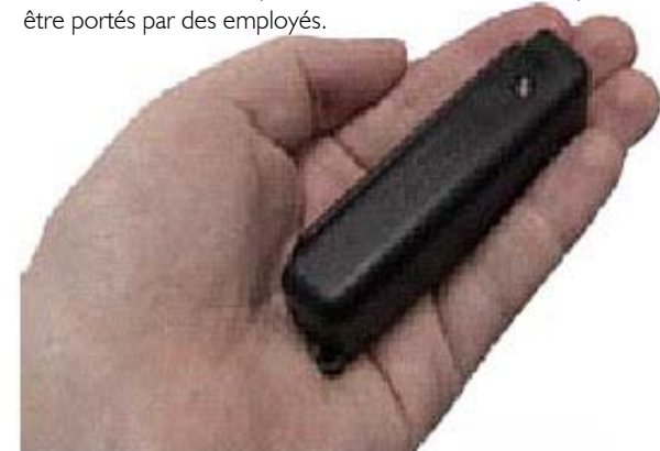
Figure 4 : Enregistreur de frappes. Cet appareil peut être branché à un clavier pour enregistrer toutes les frappes.
