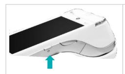
1. Appuyez sur le bouton d'alimentation situé sur le côté droit du terminal et maintenez-le enfoncé pendant plus de 2 secondes jusqu'à ce que le menu s'affiche.
