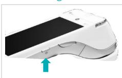
1. Appuyez sur le bouton d'alimentation situé sur le côté droit du terminal et maintenez-le enfoncé pendant plus de 2 secondes jusqu'à ce que le menu s'affiche.
